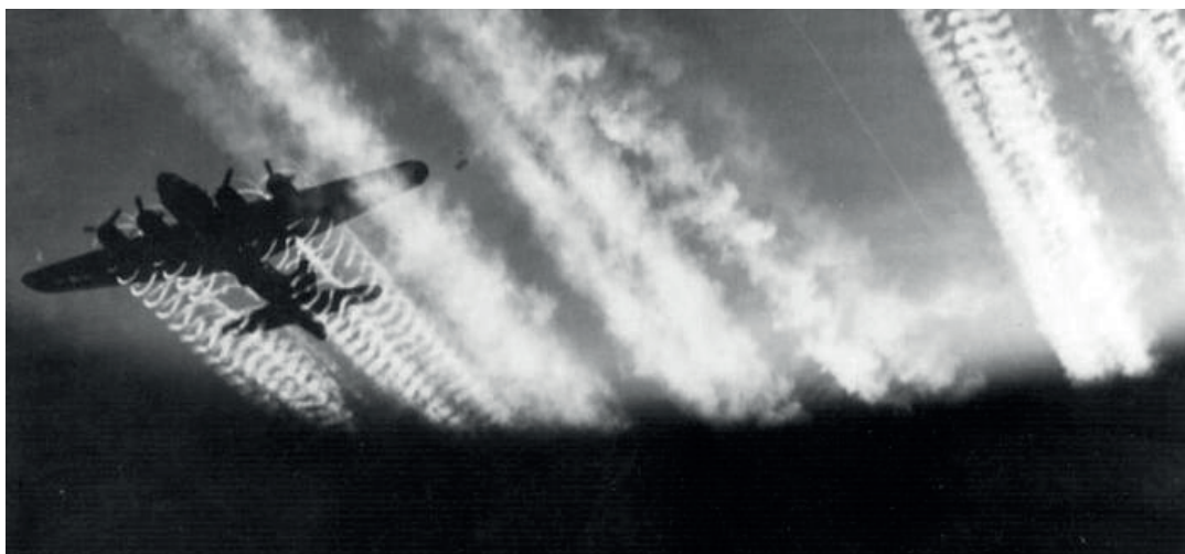
Figur 9. Propelfly, der forårsager aerodynamiske contrails.
