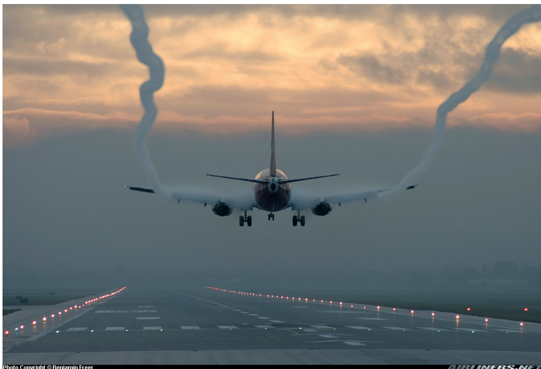
Figur 7. Trykfald-betinget fortætning af vanddamp omkring fly under landing. De udslåede flaps forøger opdriften, men forårsager dannelse af to hvirveltråde, i hvilke den fortættede vanddamp bevares som i en skypumpe. Foto: Benjamin Freer.
