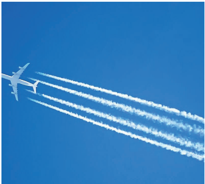
Figur 3. Kondensation af vanddamp/iskrystaller i udstødningen fra jet-motorer. Det er karakteristisk, at kondensationen først finder sted i nogen afstand fra motoren.
