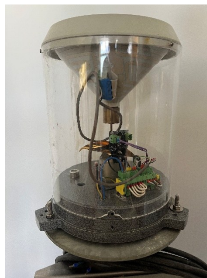
Figur 1: Demomodel af SVKs regnmåler, hvor man bl.a. kan se vippeskeen.
