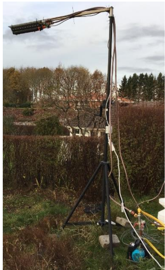
Figur 9. Mobil regnsimulator til fysisk simulering af regn og overfladeafstrømning.
