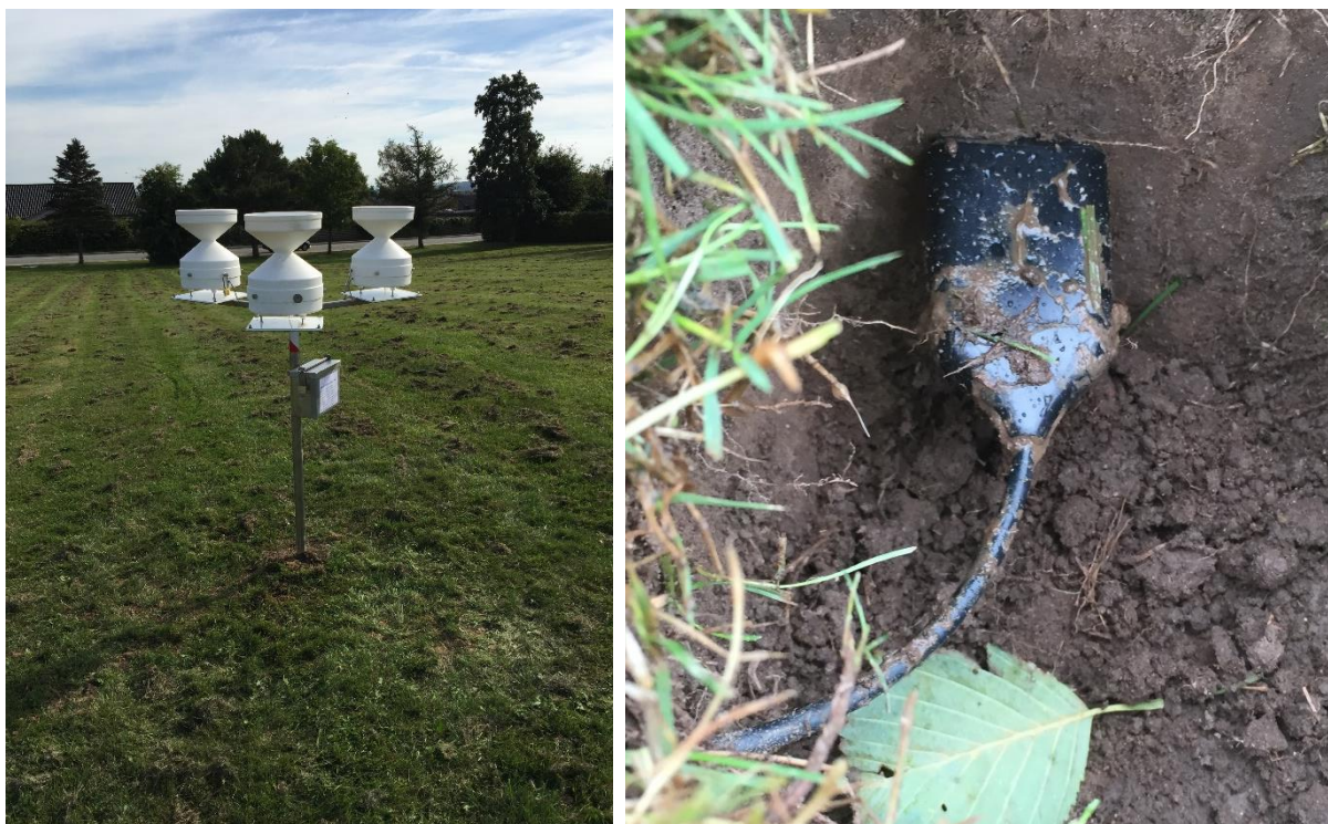
Figur 7. Tredobbelt regnmåler (t.v.) med vippekarsmålere af typen ARG100 og en monteret Decagon 5TE vandindholdsmåler i 10 cm jorddybde (t.h.).
