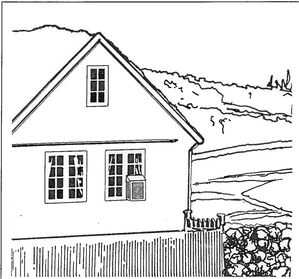
Fig. 6. Thorshavn skole med indtegnet tremmekasse for et nordvendt venstre vindue. Skolen er beklædt med sortbejset træværk, men den sorte farve er ikke gengivet her. Tegning MLB 1994.
