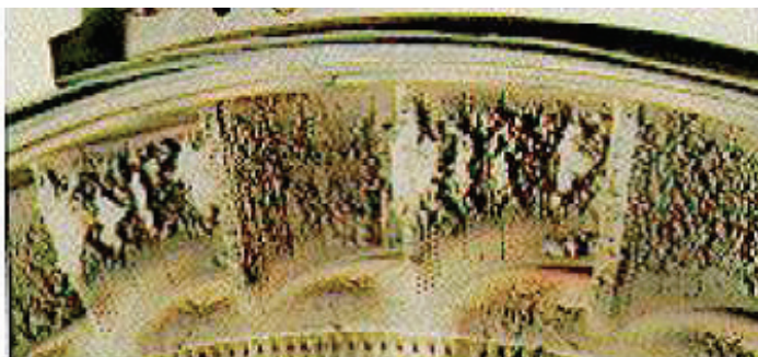
Figur 6. Rotor med belægning af vulkansk aske i jetmotoren på den British Airways Boeing 747, som nødlandede i Jakarta i 1982 efter at have oplevet komplet motorstop på grund af flyvning i vulkansk aske. Ref.: http://en.keilir.net/static/files/conferences/ejjaaviation/session5/patemmott-rollsroyce.pdf .
