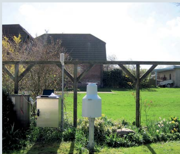
↑ Eksempler på to af DMI's meteorologiske stationer, der er beliggende ved Nordby (til venstre) og Vestervig (til højre). Ved begge stationer måles der lufttemperatur (inklusive minimum- og maksimumtemperaturer), fugtighed og nedbør. Foto: DMI's teknikere.
