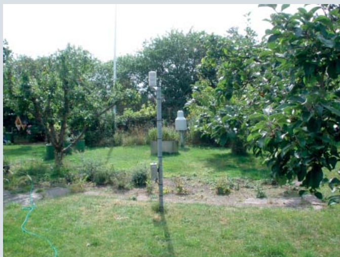
↑ Eksempler på to af DMI's meteorologiske stationer, der er beliggende ved Nordby (til venstre) og Vestervig (til højre). Ved begge stationer måles der lufttemperatur (inklusive minimum- og maksimumtemperaturer), fugtighed og nedbør. Foto: DMI's teknikere.
