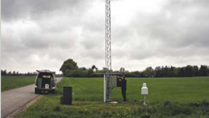
Figur 5: En af de automatiske målestationer i Danmark, som måler lufttemperaturen hvert tiende minut. Foto: DMI.
