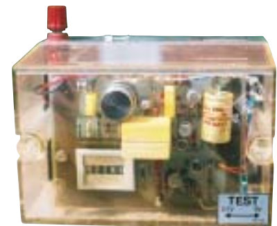
14. Gammelt lyntællerinstrument fra en af de nedtagne DMI-stationer. (L. Bruun)
