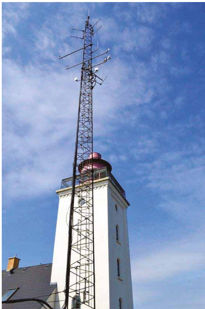
Figur 10. På en høj mast ved siden af Røsnæs Fyr er DMI's vindmåler blandt andet monteret, et godt stykke oppe for at komme fri af fyret. Vindmålingen opgives som målt i 16 meters højde. Når det stormer, er det oftest målingen fra denne mast, der opgives i medierne, men den afspejler kun de vindstyrker, man vil opleve, hvis man kravlede 16 meter op i masten. Foto taget 18. juli 2014 af Kasper Stener Hintz.
