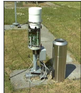
Pluvio Model 250 mm
