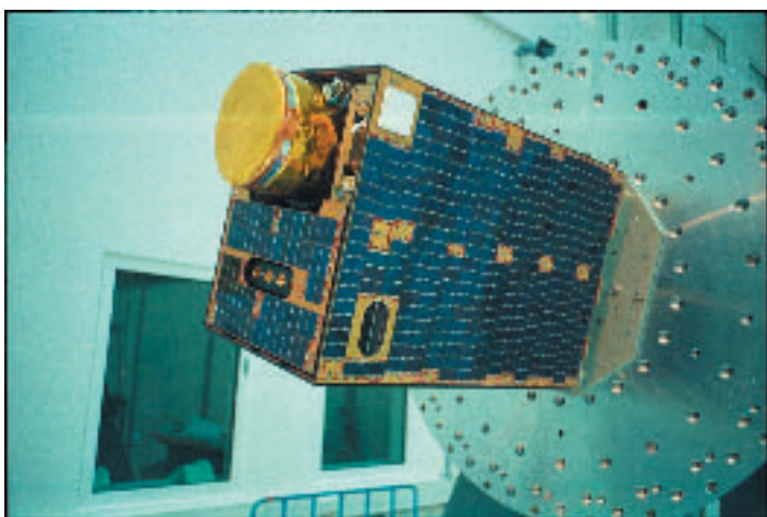
Figur 2. Ørstedssatellitten testes i IABG. Masten er sammenfoldet i kroppen (foto: Per L. Thomsen)
