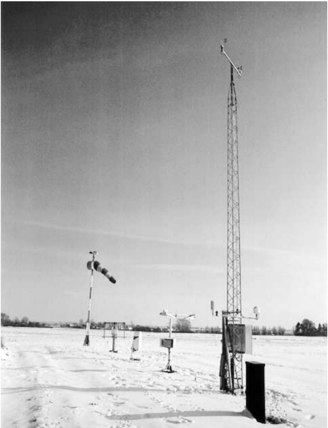
Figur 24. Mange vejrstationer var ved udgangen af århundredet blevet fuldstændig automatiske. Her ses en automatisk vejrstation ved Holbæk. Fra denne modtages hver 10. minut observationer af vind, temperatur, nedbør, stråling, relativ luftfugtighed, skyhøjdemålinger og automatiske målinger af sigt og vejrtyper. Udviklingen har været enorm siden århundrede-skiftets simple håndlæste instrumenter.
