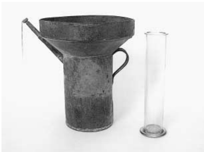
Figur 1. Ved århundredets start var vejrstationerne meget simple. Et væghængt temperaturskab og en nedbørmåler samt en vimpel i en flagstang var udstyret på en større station. Her ses et af instrumenterne nemlig N. J. Fjords regnmåler og tilhørende måleglas, der blev anvendt til nedbørmåling i Danmark fra Instituttets start i 1874. Den pågældende måler blev i 1880 sendt til Læsø, hvor den var i uafbrudt anvendelse op til september 1967, hvor den blev udskiftet med en nyere model - Hellmann måleren.
