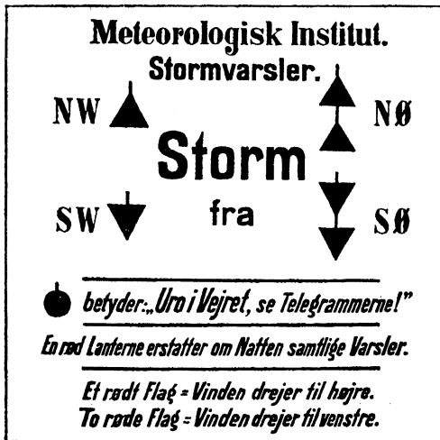
Figur 4. Stormvarsling- og kulingssignaler. De optiske stormvarsler (t.v.) er varslingssignaler af international type som fra oktober 1904 gennem ca. 20 år vistes ved kystsignalstationer (se figur 5) forskellige steder ved de danske kyster samt fra to fyrskibe. Fra juli 1906 vist desuden kulingsflag (t.h.).
