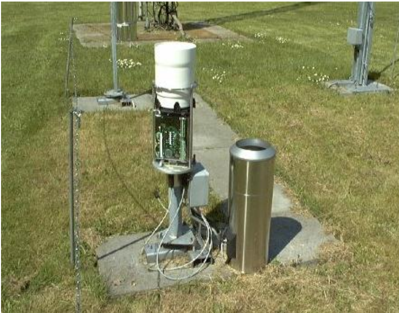
Figur 3. Den første udgave af Pluvio-måleren blev produceret med en målekapacitet på 250, 1000 og 1300 mm. Her er vist Pluvio Model 250 mm fra en testopstilling ved Westermarkelsdorf, Fehmarn (E. Lanzinger, Deutcher Wetterdienst, pers. komm.).
