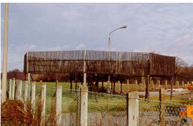
Figur 7.4. Th.: Referencemåler for sne, en såkaldt Valдай double fence med nedbørmåleren placeret i midten. Billedet er fra Harzgerode, Tyskland (WMO, 1998). Tv.: grid som er en del af referencemåleren for regn. Nedbørmålerens åbning placeres i hullet i midten. Billedet er fra testfeltet i Vovlund inden montering af referencemåler.
