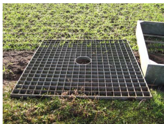
Figur 7.4. Th.: Referencemåler for sne, en såkaldt Valдай double fence med nedbørmåleren placeret i midten. Billedet er fra Harzgerode, Tyskland (WMO, 1998). Tv.: grid som er en del af referencemåleren for regn. Nedbørmålerens åbning placeres i hullet i midten. Billedet er fra testfeltet i Vovlund inden montering af referencemåler.
