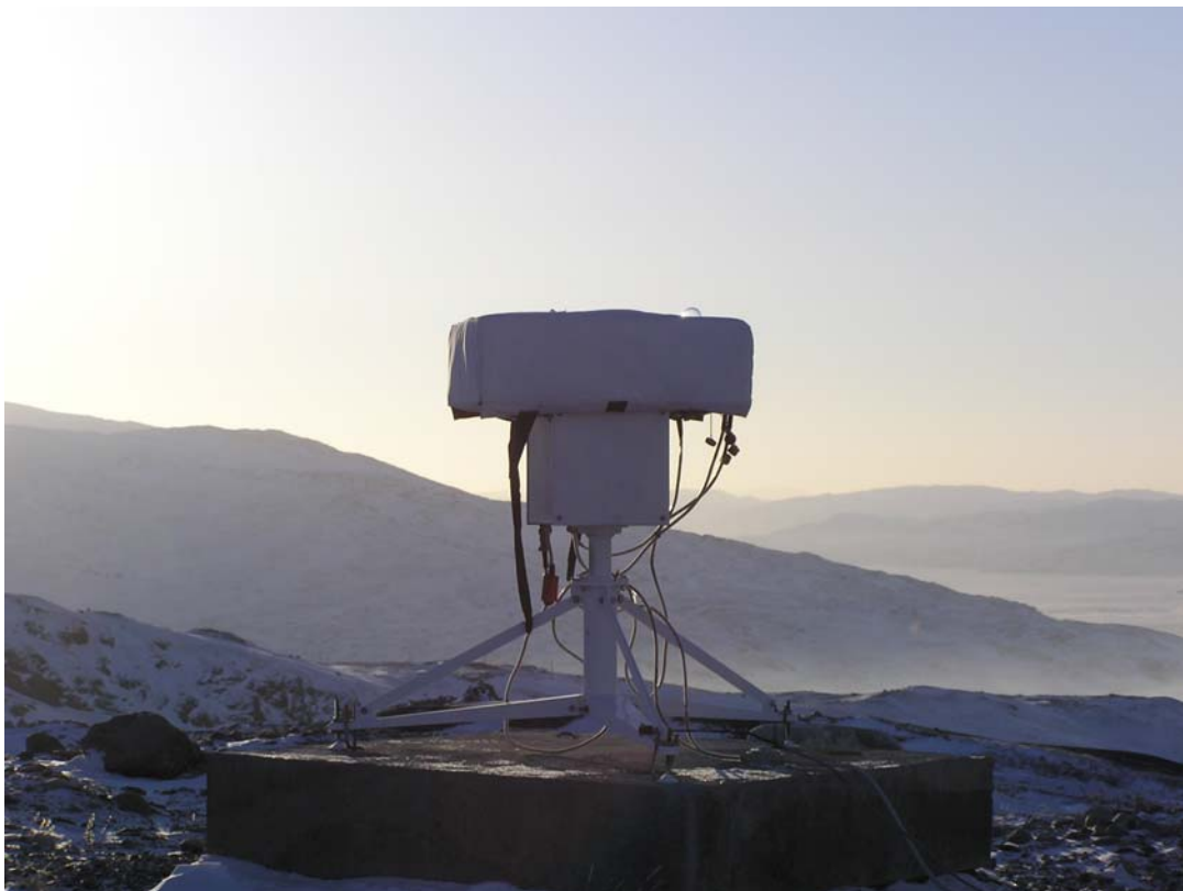
DMI's Brewer-spektrometer i Kangerlussuaq til måling af ozonlagets tykkelse og den ultraviolette stråling
