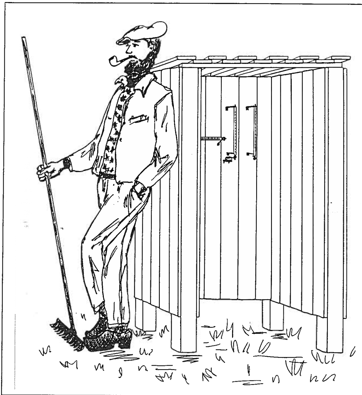
Fig. 3. Rekonstruktion af plankeskærm fra Landbohøjskolen. Taget er sandsynligvis forkert fortolket. Kilde til målene og øvrige oplysninger: Meteorologisk Årbog 1876 p. XVI. MLB 1994.
