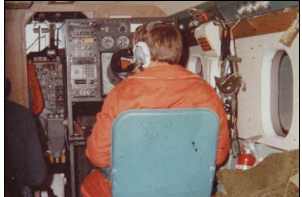
OY-ATY med sit oprindelige radarudstyr, udstyret med boblevinduer, isradar og alle relevante navigationsinstrumenter til rådighed for isobservatøren, var et mægtigt skridt fremad for den udenskærs isrekognoscering. Foto: Hans Valeur.
