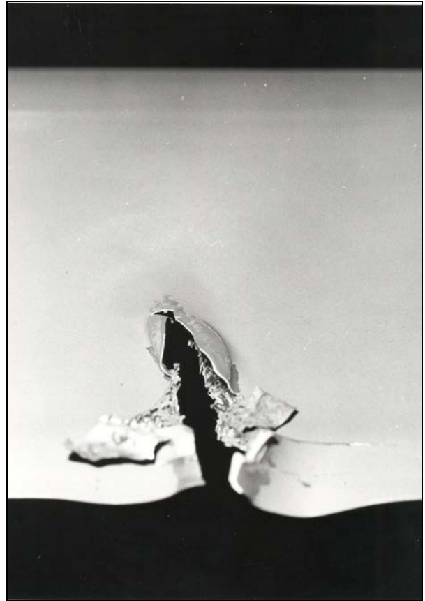
Hvis riffelkuglen havde ramt rotorbladet nogle få centimeter anderledes, kunne det have haft katastrofale følger. Foto: Iscentralen.
