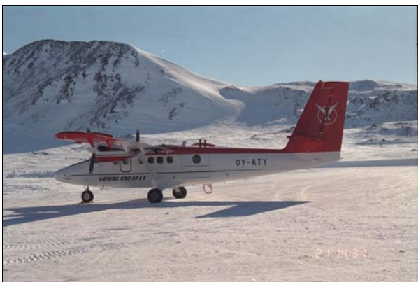
OY-ATY fotograferet i Kulusuk i 2001, hvor flyet kun var i charter for udførelse af specielle opgaver for DMI. Bemærk at radaren er afmonteret, hvilket er påkrævet for landing i ujævnt terræn. Foto: Keld Qvistgaard.
